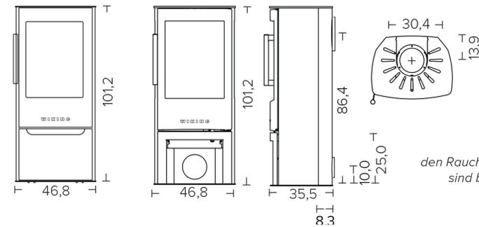
Alle Zeichnungen: Die Maße für den Rauchabgang und den Frischluftanschluss sind bis zur Mitte der Öffnung angegeben.
